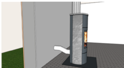
1.4 Pose conduit d'entrée d'air
