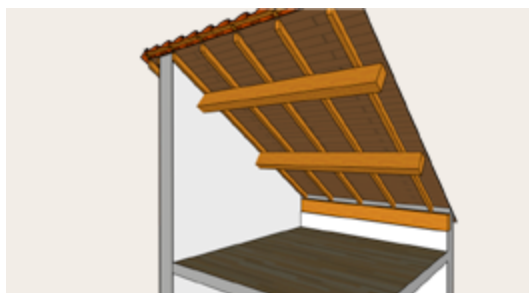
1.1 Dépose parement en plafond et celui en bas de pente
