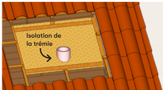
2.11 Pose complément d'isolation dans le chevêtre
