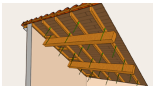
1.2 Pose des suspentes
