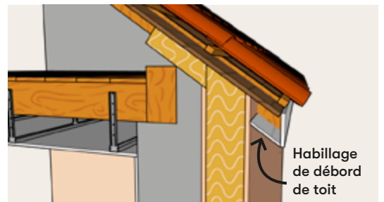
1.6 Pose de l'habillage du débord de toit
