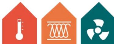
La toiture, lorsqu'elle n'est pas isolée et que **ses combles ne sont pas aménagés, joue un rôle d'espace tampon central** dans le confort d'été et d'hiver. Ventilée, elle permet l'évacuation de la chaleur en été. Non ventilée, elle réduit les besoins de chauffage en hiver. Lors des rénovations, il est donc important de respecter le fonctionnement thermique initial du bâtiment.
