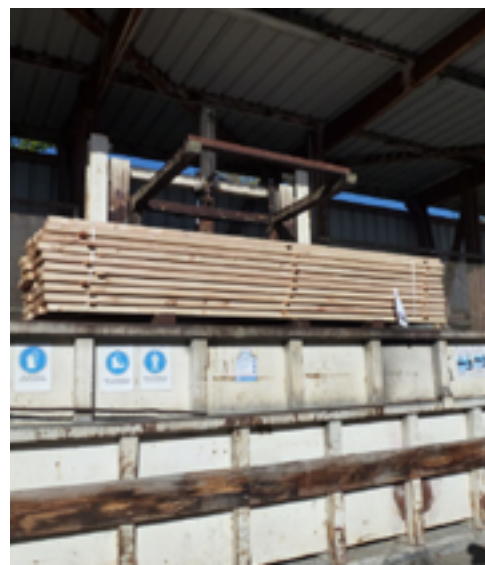
Bac de trempage - Entreprise Arbonis à Peguilhan (31)
