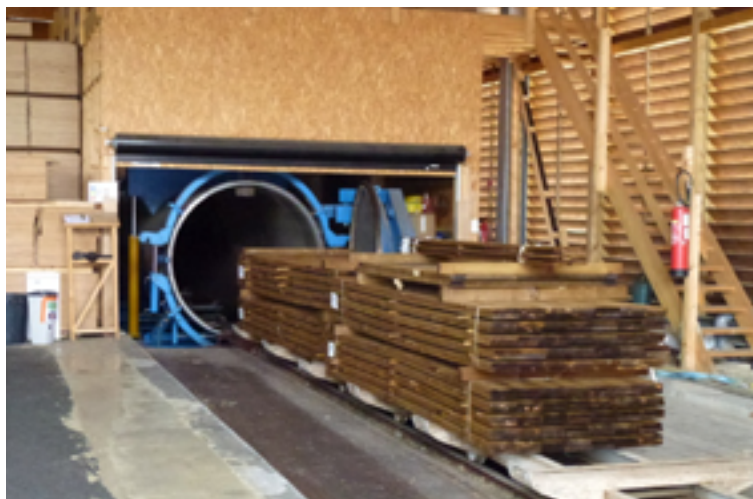
Autoclave de traitement - Entreprise Escaffre à Terssac (81)
