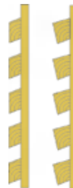
Exemples de profils de bardages ajourés en pose horizontale
