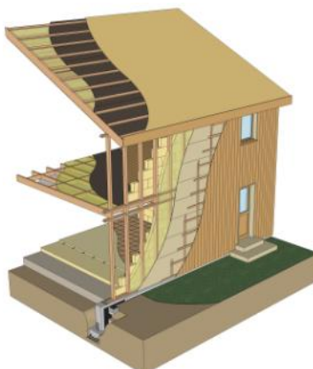
exemple de parement isolant en intérieur
